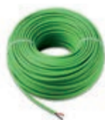
732I.E.100 Кабель Due Fili Plus для внутренней/наружной прокладки, проводники с витыми парами 2x1 мм 2 , изоляция и оболочка LSZH (малодымный безгалогенный компаунд), класс CPR Eca, рабочая температура -25/+70 °С, класс изоляции 600/1000 В, пригоден для подземной прокладки в сухих трубах или трубах с дренажом (макс. время нахождения в мокром состоянии 24 ч), непригоден для прокладки непосредственно в земле, пригоден для укладки в одном коробе с кабелями I категории (U0 = 400 V) зеленый - моток длиной 100 м
