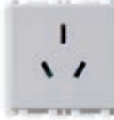
14261.SL 2П+3 10 А, австралийский стандарт - 2 модуля. Глубина: 28,2 мм
