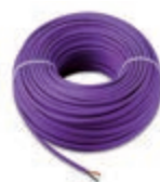
▲ 732I.C.100 Кабель Due Fili Plus для внутренней/наружной прокладки, проводники с витыми парами 2x1 мм 2 , изоляция и оболочка LSZH (малодымный безгалогенный компаунд), класс Cca - s1b, d1, a1, рабочая температура -25/+70 °С, класс изоляции 600/1000 В, пригоден для подземной прокладки в сухих трубах или трубах с дренажом (макс. время нахождения в мокром состоянии 24 ч), непригоден для прокладки непосредственно в земле, пригоден для укладки в одном коробе с кабелями I категории (U0 = 400 V), фиолетовый - моток длиной 100 м
