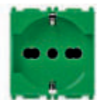
14210.AB.V 16 А, универсальная, зеленая, антибакте- риальной обработки - 2 модуля. Глубина: 25 мм
