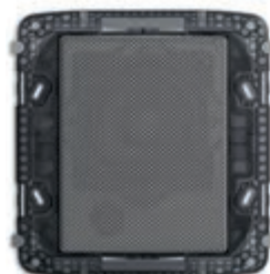
21588.N Пассивный диффузор звука 8 Ω 10 Вт - 8 модулей. Глубина: 48 мм
