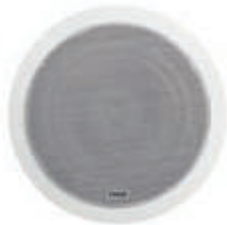
01907 Пассивный диффузор звука 8 Ω 30 Вт, установка на тонких стенках и подвесном потолке. Глубина: 68 мм
