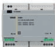
01901 Стереосулитель 2 выхо- да для диффузоров звука 8 Ω 10 + 10 Вт, питание 110-230 В 50/60 Гц, встроенный ограничитель линии, 6 модуля x 17,5 мм
