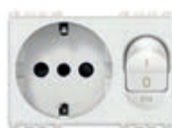
19276.B 16 А P30 250 В~, 1П+N С 16 - 3 модуля. Глубина: 39,6 мм
