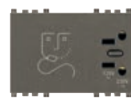
▲19290.M 230 В~ 50/60 Гц, с разделительным трансформатором 20 ВА, 230 В~ и 120 В~ выходы - 3 модуля. Глубина: 41,5 мм
