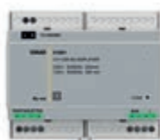
01901 Стереоусилитель 2 выхода для диффузоров звука 8 Ω 10+10 Вт, пита- ние 110-230 В 50/60 Гц, встроенный ограничи- тель линии, 6 модуля x 17,5 мм
