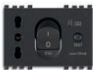
19283 Вpresa 16 А P17/11 250 В~, 1П+N С 16 - 3 модуля. Глубина: 39,6 мм
