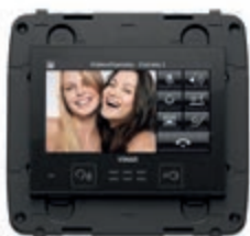
21554 Сенсорный видеоскрэн 4,3" Full Flat, для внутреннего поста системы видеодомофонии Due Fili Plus, служащий для контроля и управления, вход для подключения датчика температуры, с держателем для установки в коробки на 8 модулей. Глубина: 46,7 мм
