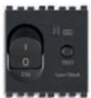
19411.16 С 16, I Δn 10 mA отключающая спо- собность 3000 А - 2 модуля. Глубина: 39 мм
