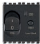
19411.10 С 10, I Δn 10 mA отключающая спо- собность 3000 А - 2 модуля. Глубина: 39 мм
