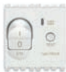
19411.10.B С 10, I Δn 10 mA отключающая спо- собность 3000 А - 2 модуля. Глубина: 39 мм
