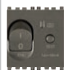
▲19411.16.M С 16, I Δn 10 mA отключающая спо- собность 3000 А - 2 модуля. Глубина: 39 мм
