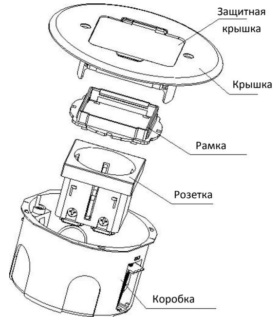
**ВНИМАНИЕ!** Степень защиты IP44 возможна только при полностью закрытой крышке лючка, при этом не допускается ни каких внешних подключений к электроустановочным/информационным/мультимедийным модулям, установленным в лючке.
